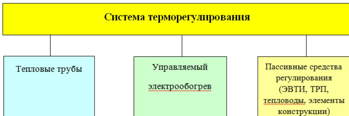
Рисунок 1.8 – Структурная схема системы терморегулирования КА негерметичного исполнения
