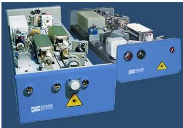
Рисунок 2.6 – YAG -Nd лазер
